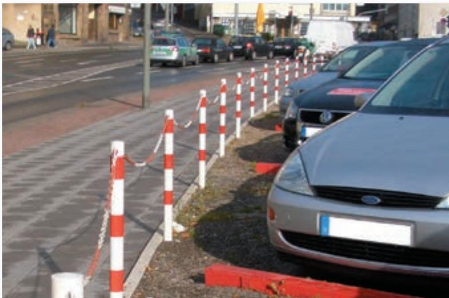
Dieser Absperr- oder Kettenpfosten kann als Begrenzungspfosten von Fußgängerbereichen, Parkplätzen, Fahrbahnen, Sicherheitszonen usw. eingesetzt werden.
